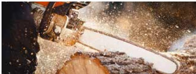
**La chaîne, tout comme le moteur de la scie a besoin de lubrification. L'utilisation de l'outil sans lubrification de chaîne est extrêmement dangereuse.**
